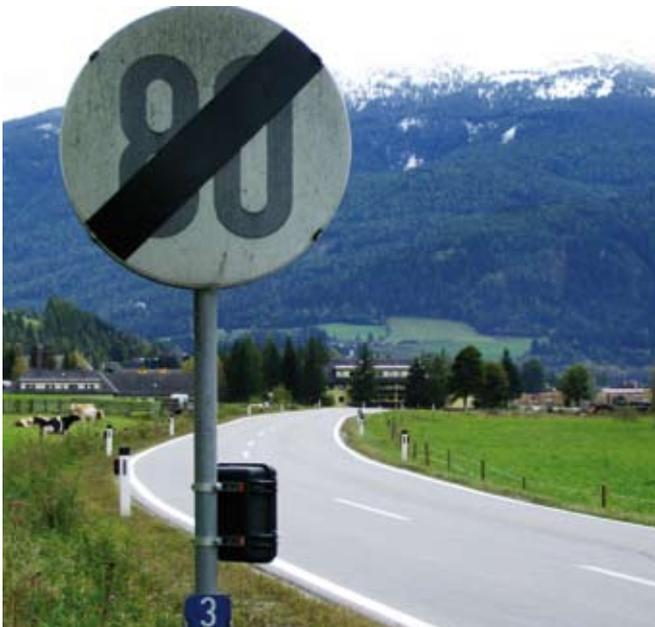
Abb. 23: Moderne Verkehrszählgeräte mit Radarerfassung messen auch die Geschwindigkeiten aller Fahrzeuge.
